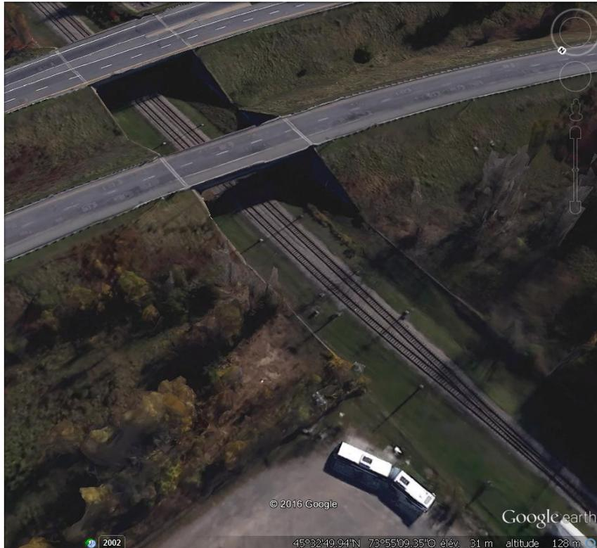
Figure 2-17 : Exemple d'étagement supérieur de la route au-dessus d'une voie ferrée
