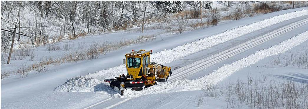
Figure 5-1 : Régaleuse sur une section au sol de l'antenne Deux-Montagnes
