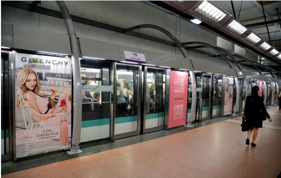
Figure 7-29 : Exemple d'une station de train avec portes palières (station ligne 14 - Paris)
