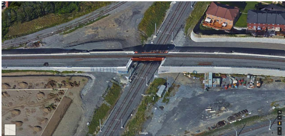
Figure 7-17 : Exemple d'étagement de voie ferrée (1)
