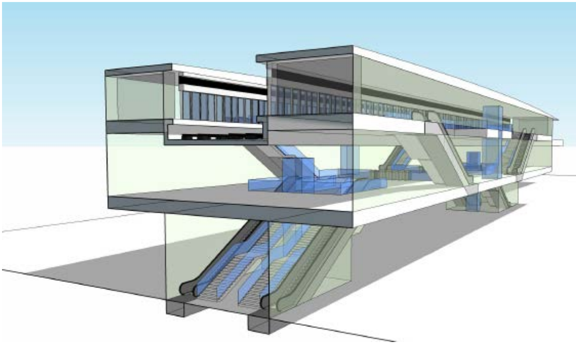
Figure 7-27 : Croquis - Vue 3D - station projetée en surélevé
