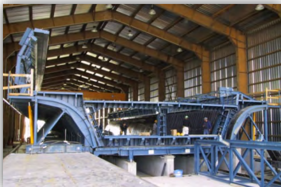
Photographie 7-12 – Ligne de préfabrication de voussoirs
