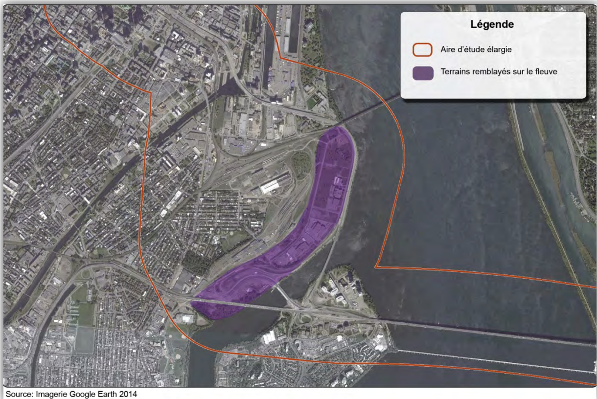
Figure 5-25 – Terrains problématiques de la PSC : le PEPSC et les terrains adjacents à l'ouest
