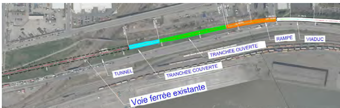
Figure 6-4 : Trémie d'accès au tunnel – Option D
