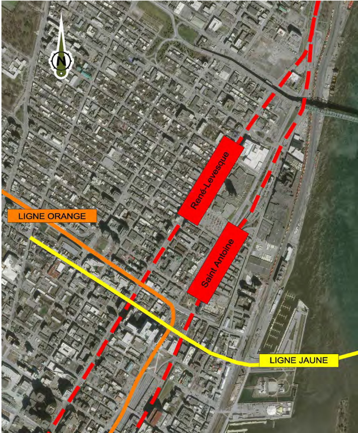
Figure 5.2.a.- Croisements des corridors à étudier avec les lignes de métro existantes. (Source: Geocontrol).
