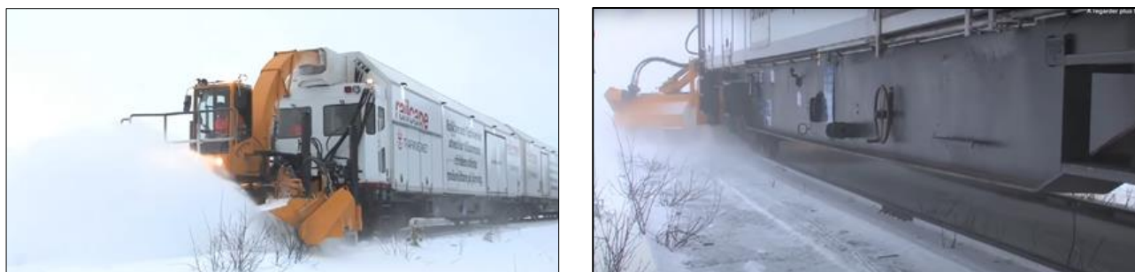
Figure 2-8 : Train déneigeur aspirant la neige pour la faire fondre et la stocker en eau
